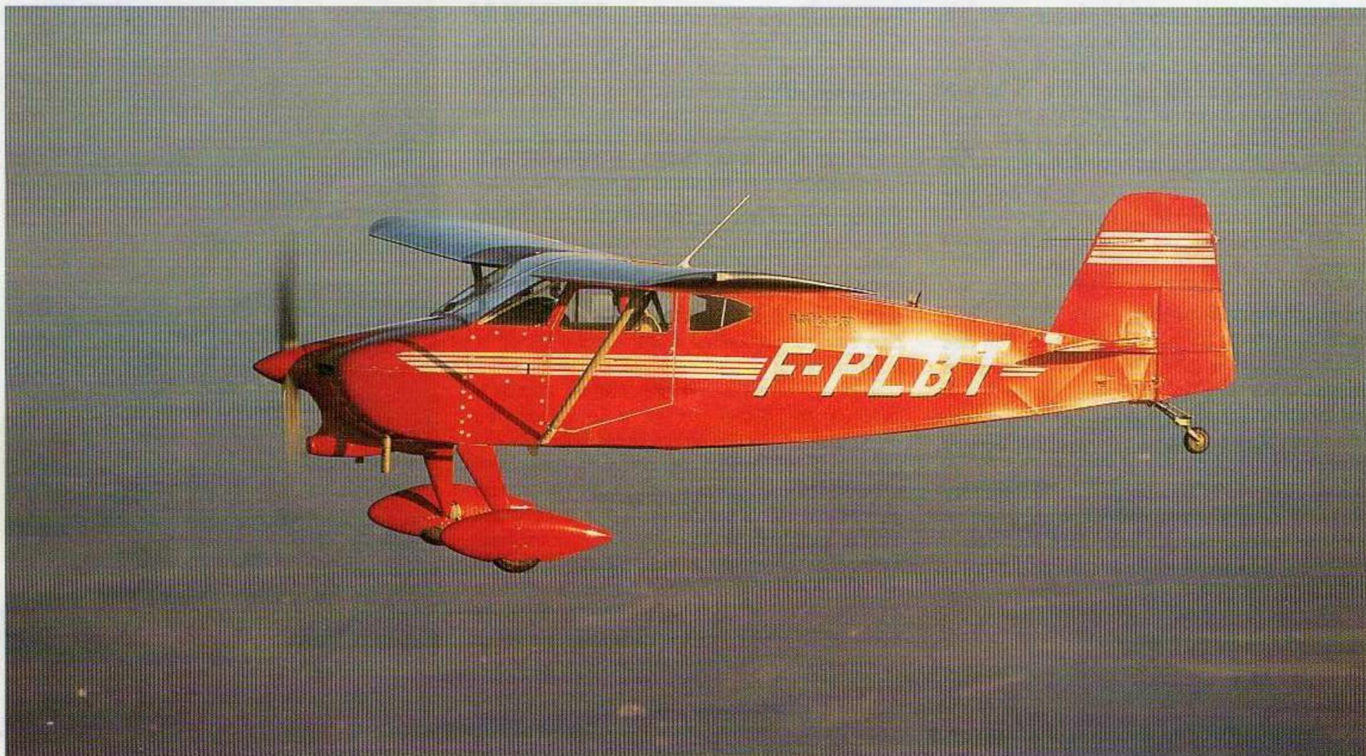
mobiles sont les plus réduites possible, l'aile rectangulaire est, elle aussi, relativement petite, elle offre une très faible traînée, enfin le fuselage en forme de profil d'aile est porteur, lui aussi, et se signale par un très faible CX. Le décrochage se produit en lisse vers 90 km/h. Nous avons, en fait, plus à faire à un enfoncement qu'à une abattée, le Taiwind se "dandine" d'une aile sur l'autre avant de commencer à descendre, il suffit de
